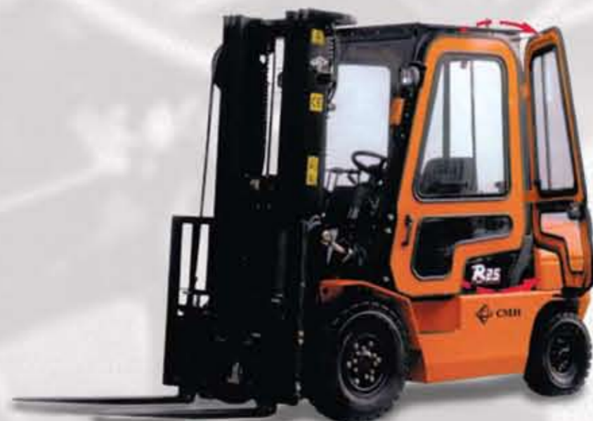
Cabine fechada com ar condicionado
